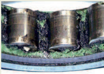
Achteruitgang van de smering, veroorzaakt door stroomdoorgang
