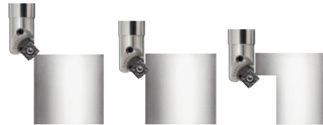
Buitenfasen Het maken van groeven Achterwaarts zakken
